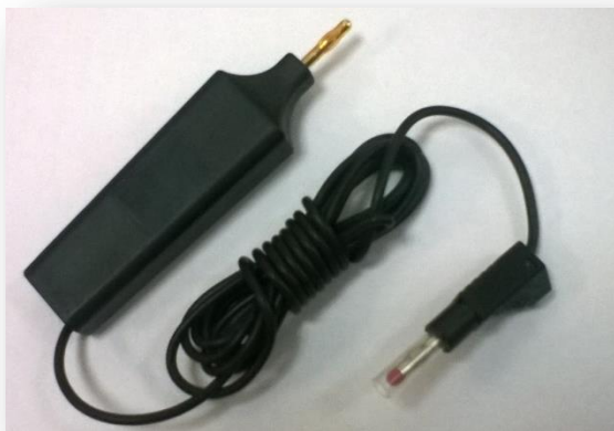
Рисунок 6 Внешний вид измерителя фазы СК-001
